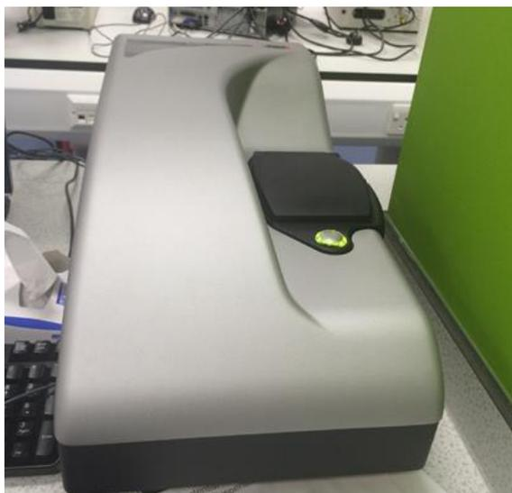
**Figure 3-6.** Malvern Zetasizer ZSP laser analyser.
