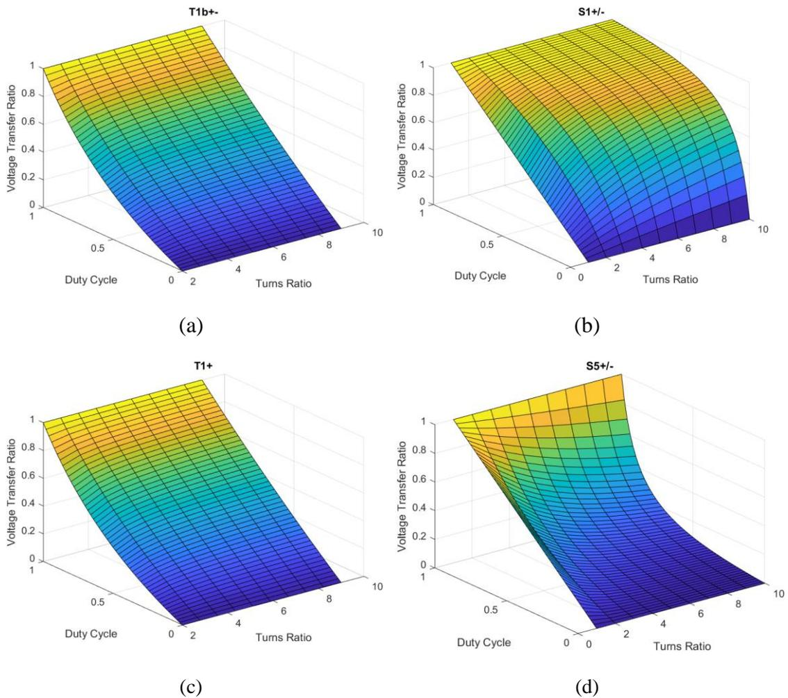
Fig. 2.8 Step down ratio versus duty cycle and turns ratio (a) T1b+/-, (b) S1+/-, (c) T1+, and (d) S5+/-.
