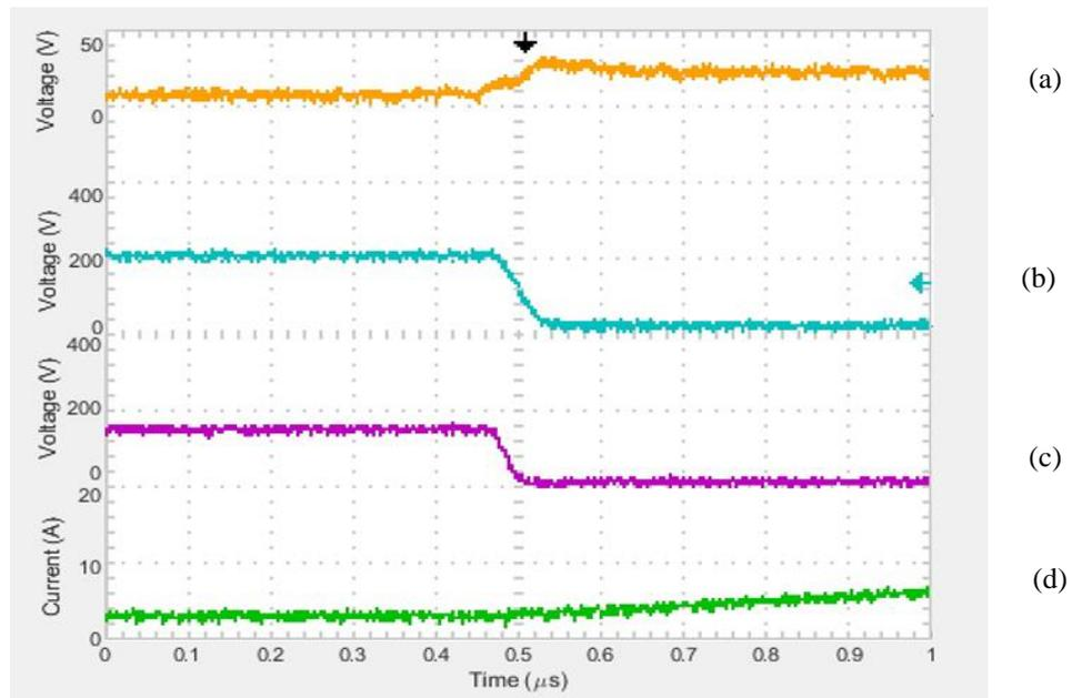
Fig. 6.14 Falling edge. (a)  $Q3$  Switch Voltage ( $V_{ds}$ ), (b)  $Q1$  Switch Voltage ( $V_{ds}$ ), (c)  $Q2$  Switch Voltage ( $V_{ds}$ ), (d) Primary ( $L1$ ) inductor current
