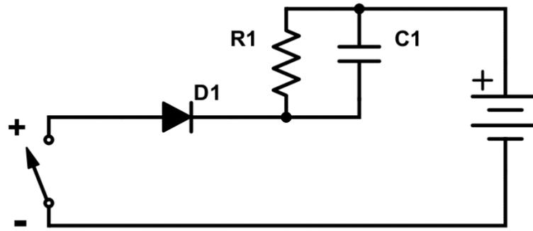
Fig. 2.28 RCD Snubber
