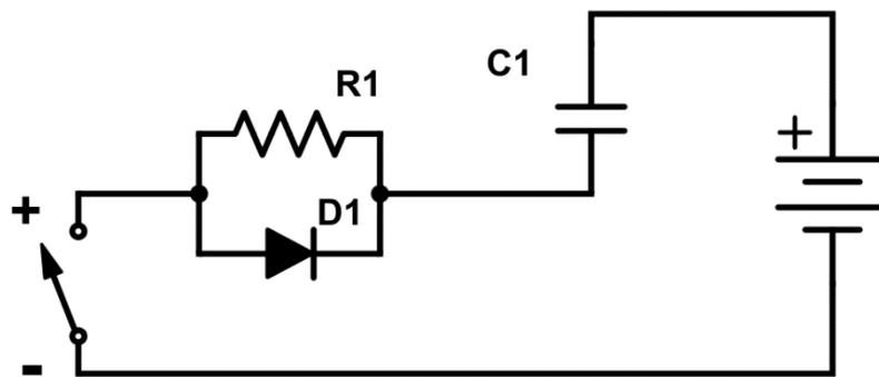
Fig. 2.26 RCD Snubber
