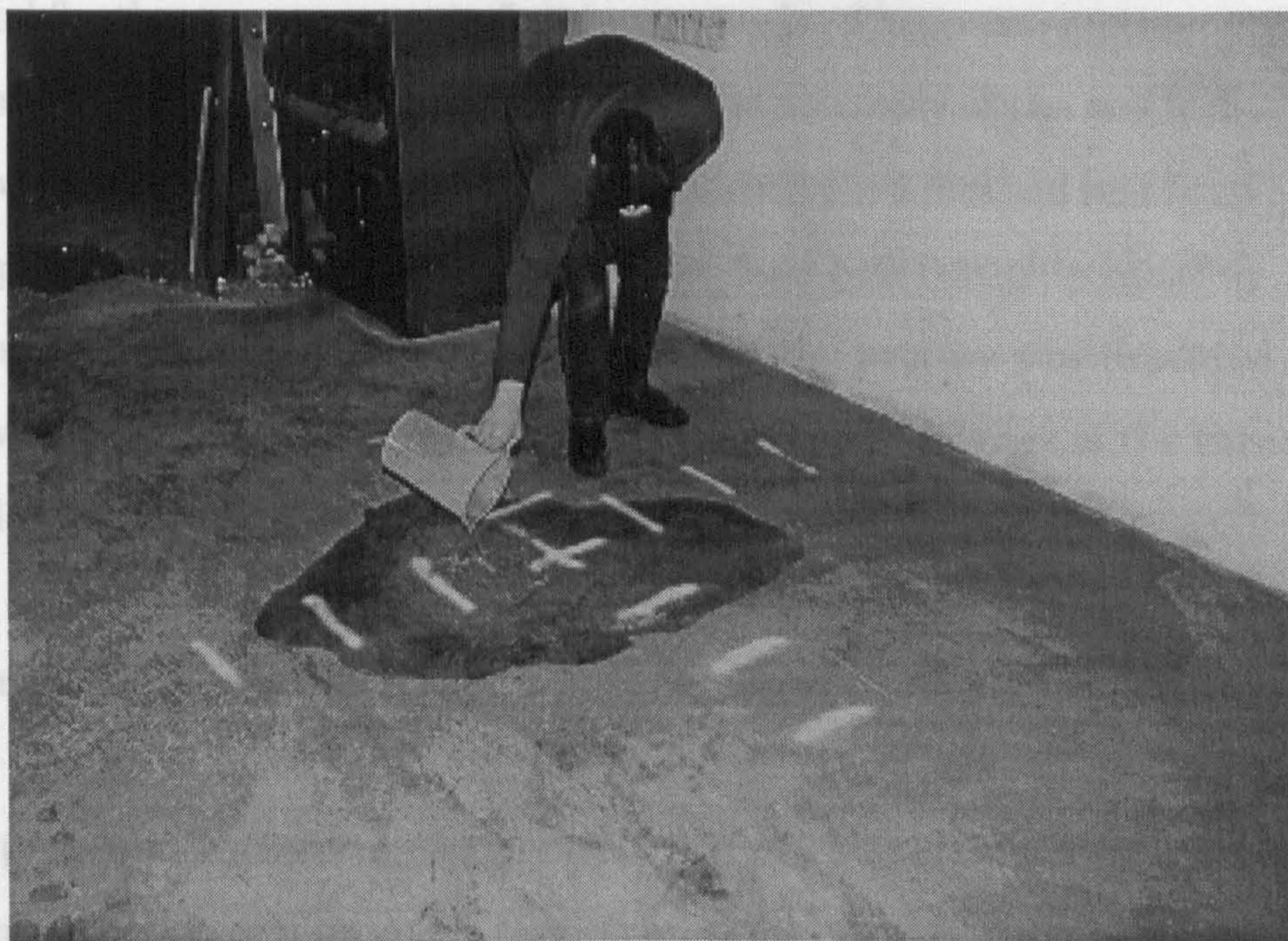
Fig. 2.1.1: Typical pool pour test – one litre methanol on concrete.
