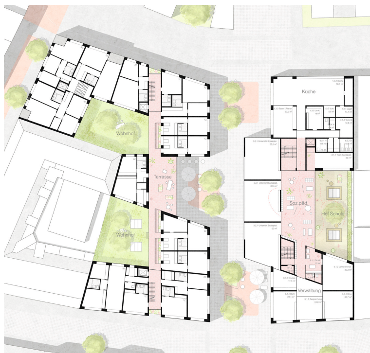
Grundriss 1. Obergeschoss M. 1:750
