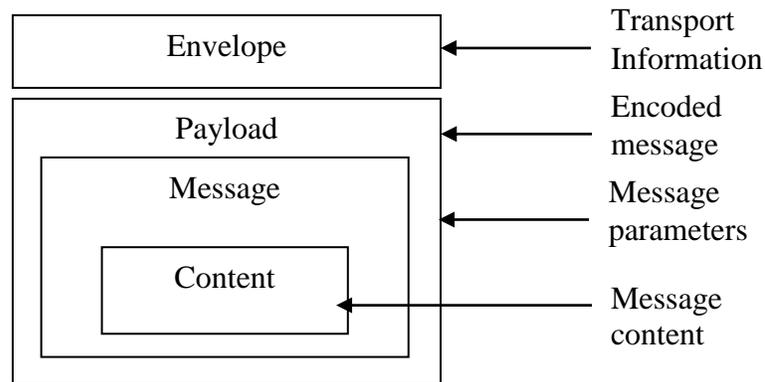
**Figure 4.4: FIPA message structure (Bellifimine et al 2007a)**
