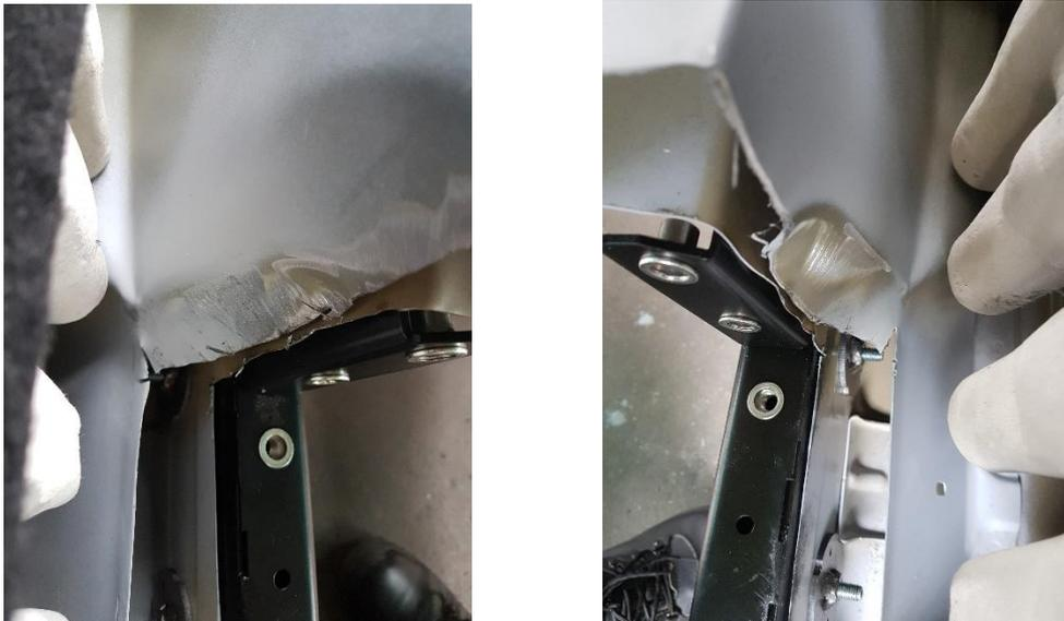
**Figure 5:** Edge deformation
