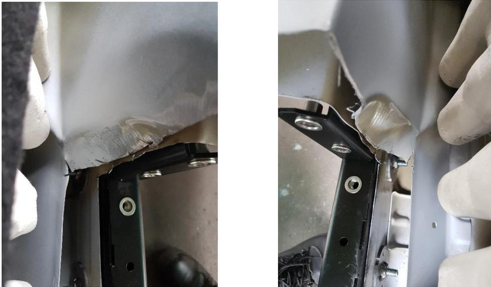
**Figure 5:** Edge deformation
