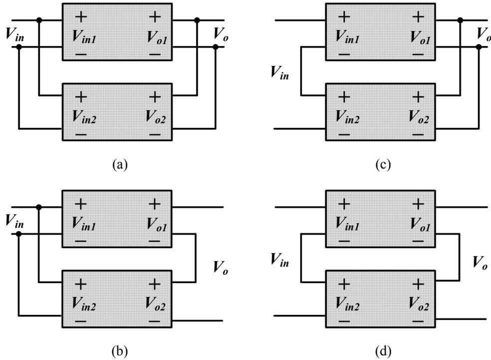
Fig. 2.5: Four possible input-output connections (a) IPOP, (b) IPOS (c) ISOP, and (d) ISOS.
